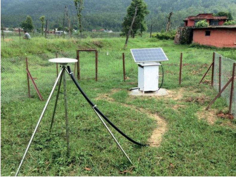
Şekil 9: Gorkha Depremi'nden hemen sonra Katmandu Vadisi'nin güneyinde kurulmuş sürekli GPS istasyonu.
